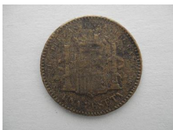
Fig.39. Diferentes productos de corrosión en la moneda N°6.
