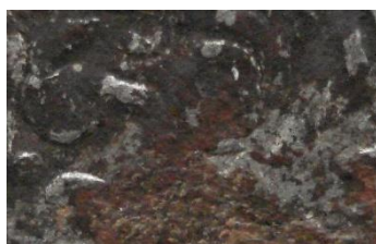
Fig.32. Productos de corrosión de la plata y el cobre. Ampliación al 25%.
