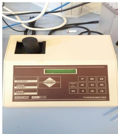
**Figura 4.1.3.1. Turbidímetro DINKO.**
