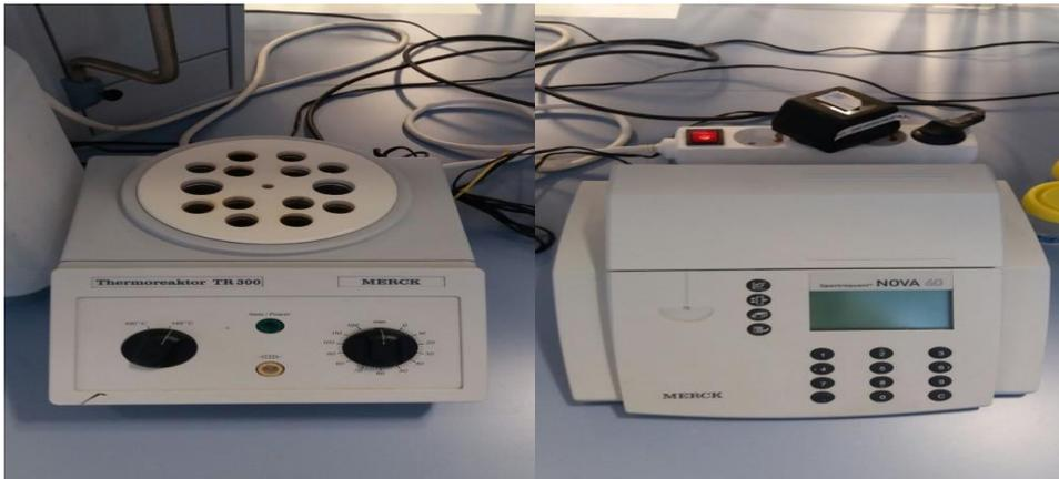
**Figura 4.1.1.1. Termoreactor y fotómetro para la medición de DQO.**
