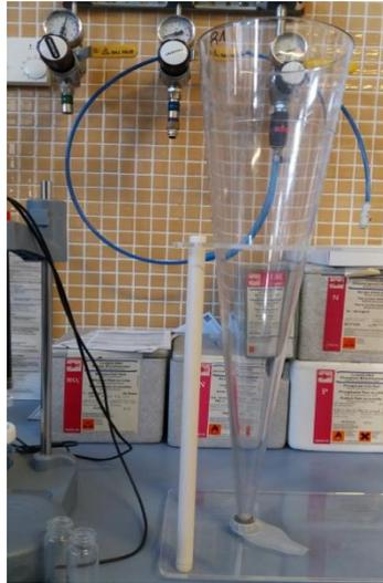
**Figura 4.2.1.1. Cono Imhoff para la realización de la V-30.**
