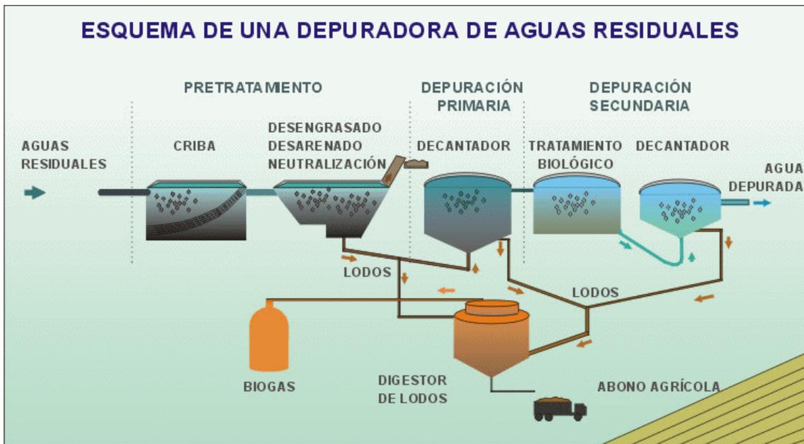
**Figura 1.1.1 Esquema de una depuradora de aguas residuales.**
