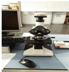
**Figura 4.2.2.1. Microscopio VisiCam para el seguimiento del fango biológico.**
