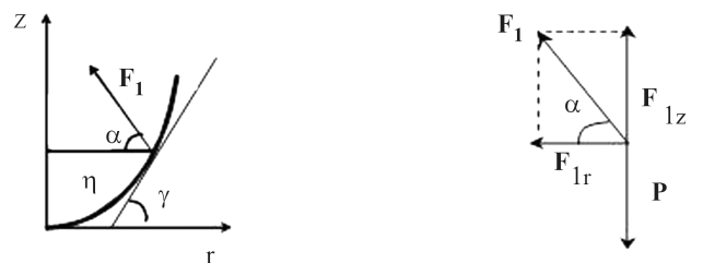
Figura 1 - (a) Vista lateral del movimiento de rotación de un fluido. (b) Esquema de las fuerzas actuando a distancia r_1 del eje de rotación.
