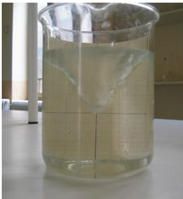
Figura 3 - Fotografía del experimento justo después de la formación de un vórtice no estacionario producido por la agitación con la cuchara. Los dos ejes z y r están dibujados sobre papel milimetrado para facilitar la toma de datos para el perfil de z(r) .
