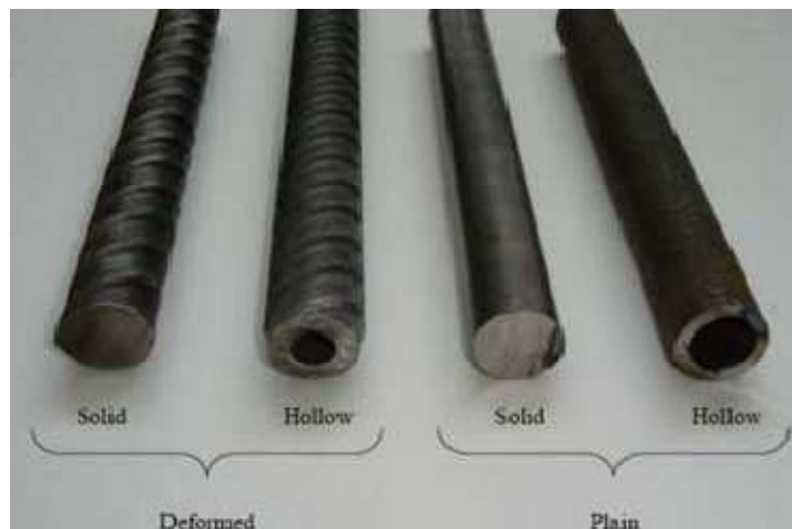
Imagen 3.13. Ejemplo de las configuraciones de los refuerzos de FRP.
