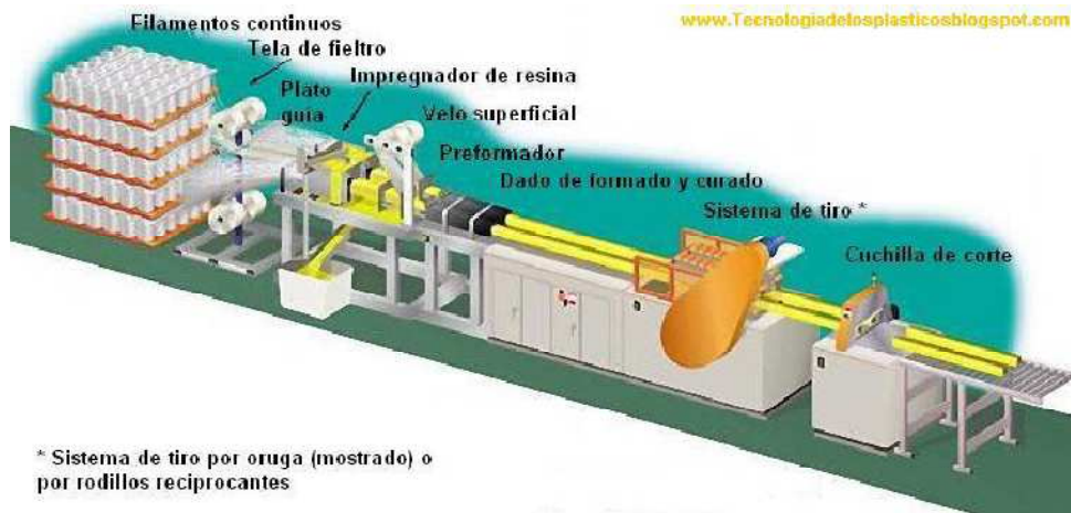
Imagen A3.5. Proceso de fabricación de las barras de fibra de basalto.
