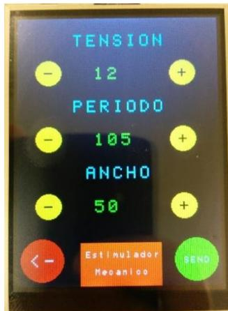
Figura 37. Pantalla para controlar el valor progresivamente y acceso al menú de estimulación mecánica.
