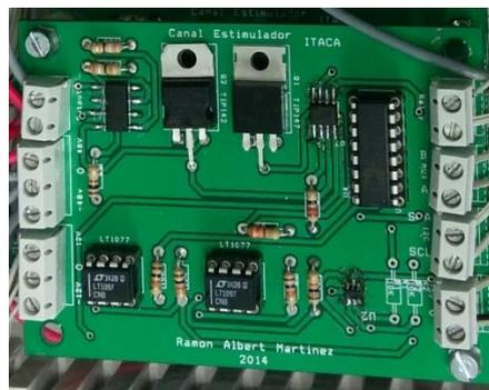
Figura 26. Fotografía PCB utilizada en estimulador.
