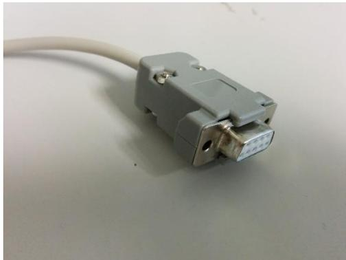
**Figura 17. Conector DB9 para el conexionado del estimulador mecánico.**
