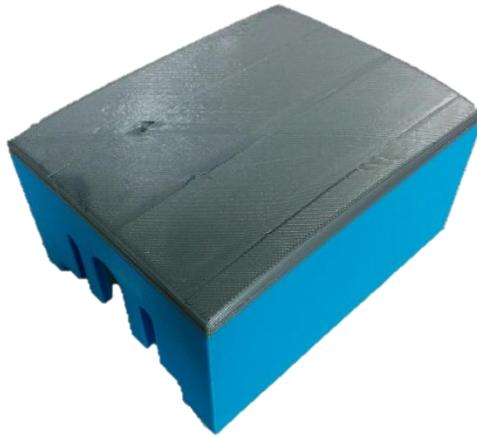
**Figura 18. Tapa para resguardar las células.**
