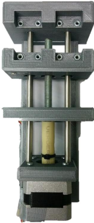
**Figura 16. Estimulador mecánico vista de planta.**
