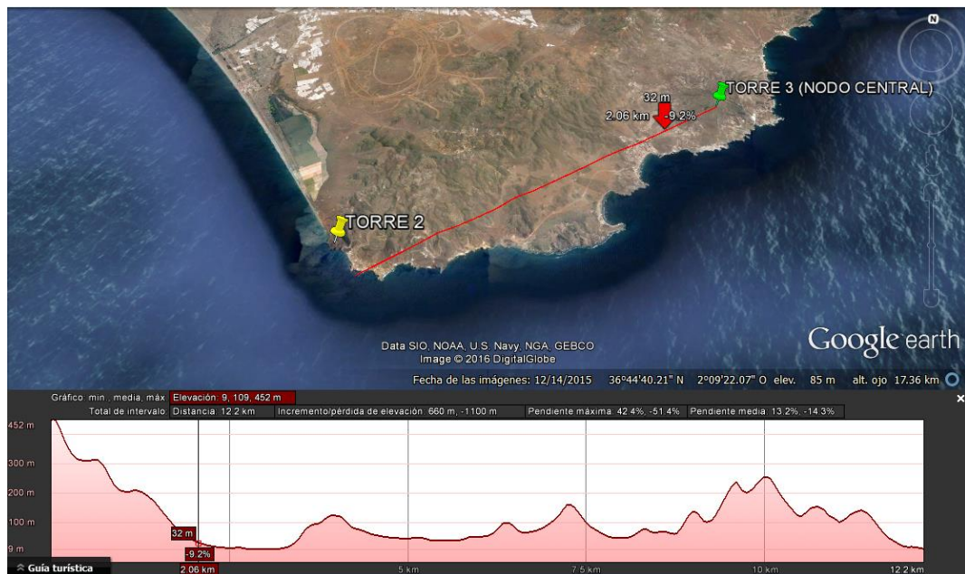
Fig.39 Visibilidad en la Dirección Sur para la Torre 3
