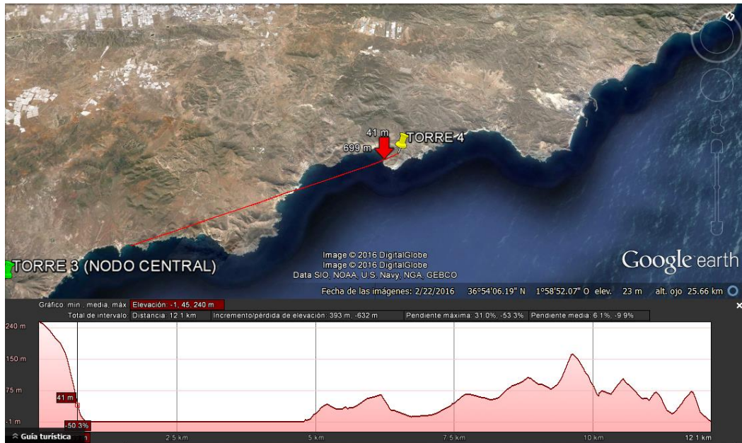
Fig.46 Visibilidad en la Dirección Sur para la Torre 4
