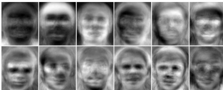
Figura 3.10 - Representación a modo de imágenes de cada 12 componentes obtenidas tras un análisis PCA.
