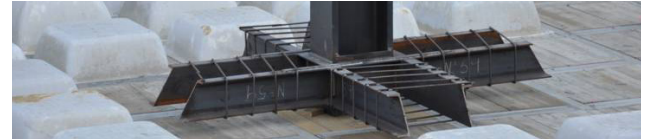
Figura 128. Crucetas UPN con estribos oblicuos embebidas.
