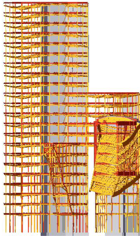
Figura 131. Deformada global. ELS 1. (f=50)
