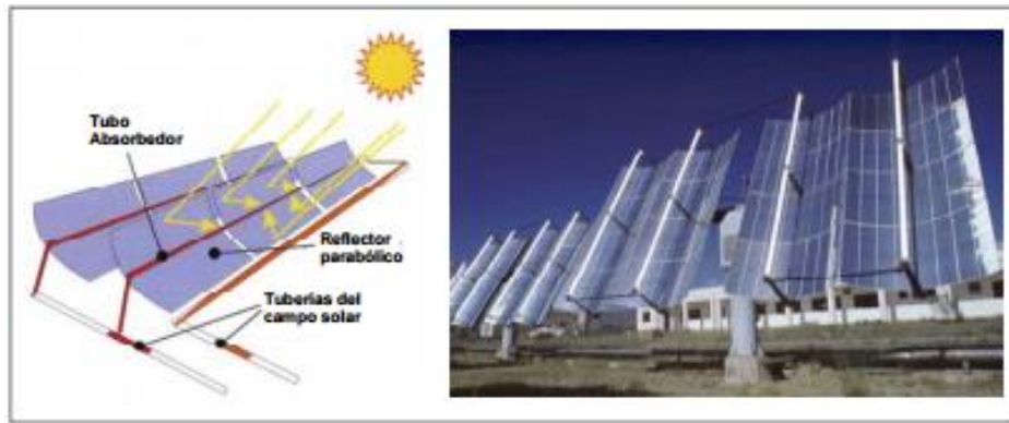
Figura 6 Esquema de CCP con seguimiento en un eje (izquierda) y foto de un CCP con seguimiento en dos ejes (derecha)
