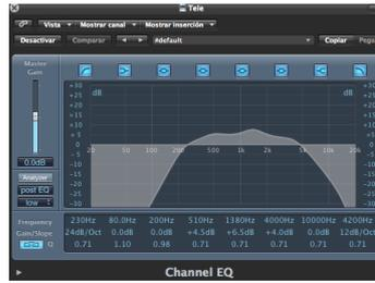
Una vez ecualizada se le añade un compresor de manera suave para compactar la voz y los niveles. Además por último se añade una reverb mediante la herramienta “space designer” para simular una estancia con mucha reverb en las frases finales. Este efecto se controla mediante automatización, dejándolo sin funcionar todo el capítulo hasta el momento final donde se requiere.
