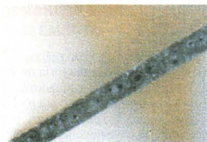
Fig. 1.—Detalle de corrosión por picaduras en una muestra de acero AISI 420, templado y revenido, sometida a un ensayo de inmersión en cloruro férrico al 10% y a 50 °C.
