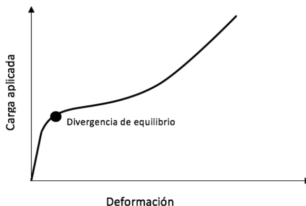
Figura 6.1: Esquema de la divergencia del equilibrio. Fuente: Elaboración propia.
