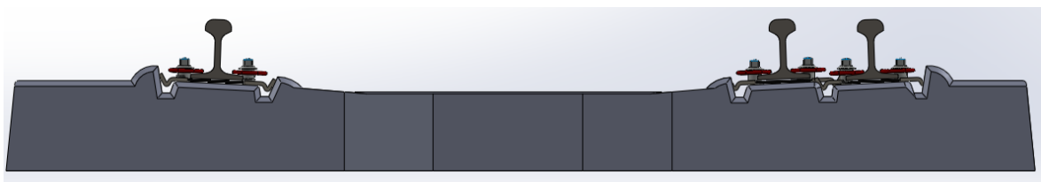
Figura 8.6: Imagen de vía con 3 carriles, representativa de la asimetría. Fuente: Elaboración propia.
