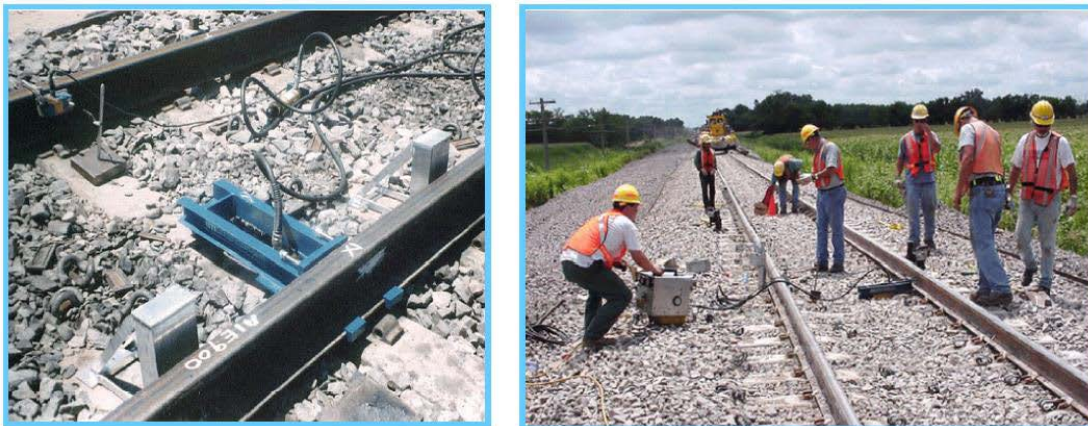
Figura 3.25: Ensayo STPT. Fuente: Recuperado de Kish, On the Fundamentals of Track Lateral Resistance , 2011.
