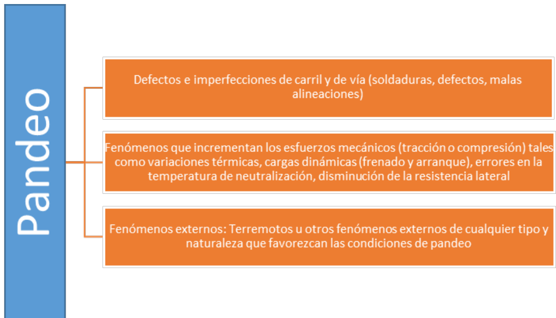
Figura 2.27: Esquema de factores que condicionan el pandeo. Fuente: Elaboración propia.
