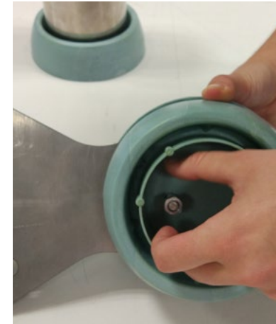
Fig. 105 Colocación de tuercas.
