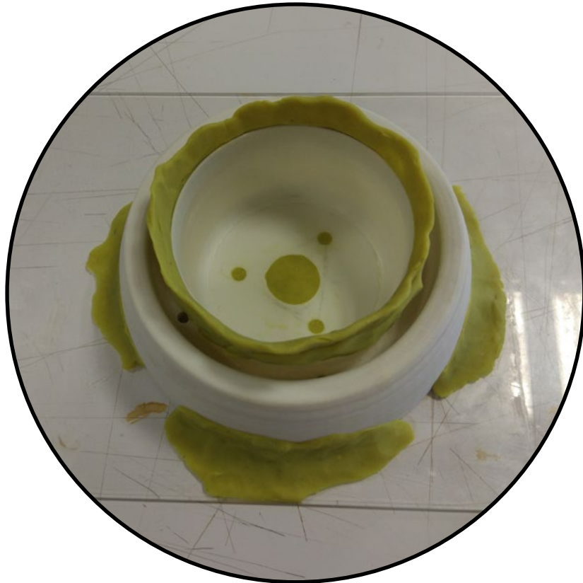
Fig. 76 Preparación de la pieza para la colada del primer macho.
