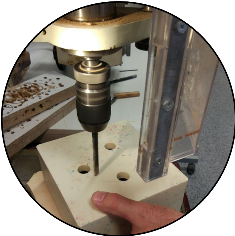
Fig.87 Realización de los orificios para los tornillos.
