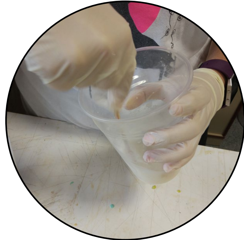
Fig.77 Preparación de la resina para el vertido.
