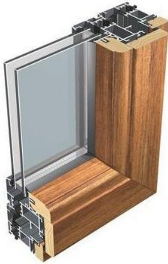
Figura 73. Detalle de ventana de aluminio y madera con rotura de puente térmico. Fuente: http://www.archiproducts.com .
