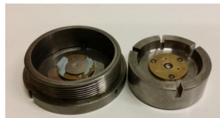
Colocación gasket y carga de muestra y medio transmisor
