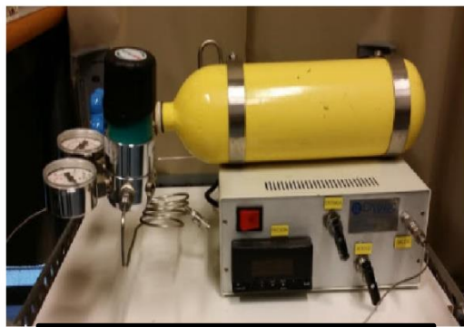
Sistema de compresión de membrana
