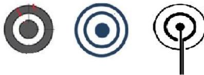
Figura 9. Representación de las tres configuraciones en los electrodos concéntricos. A la derecha se muestra la configuración de electrodo bipolar concéntrico, en el medio la configuración del electrodo tripolar concéntrico y por último se muestra la configuración del electrodo tripolar concéntrico con configuración de bipolar. (Casado, Zena, Pract & Ye, 2013)
