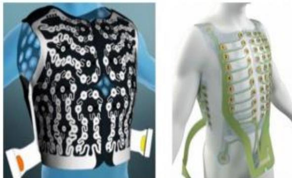
Figura 6. Representación de diferentes sistemas de BSPM para el registro del ECG en toda la superficie del torso.
