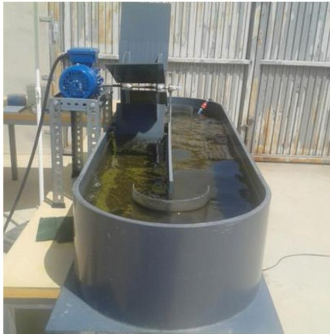
**Imagen 1.4.** Modelo de reactor raceway o de carrusel utilizado para depurar aguas
