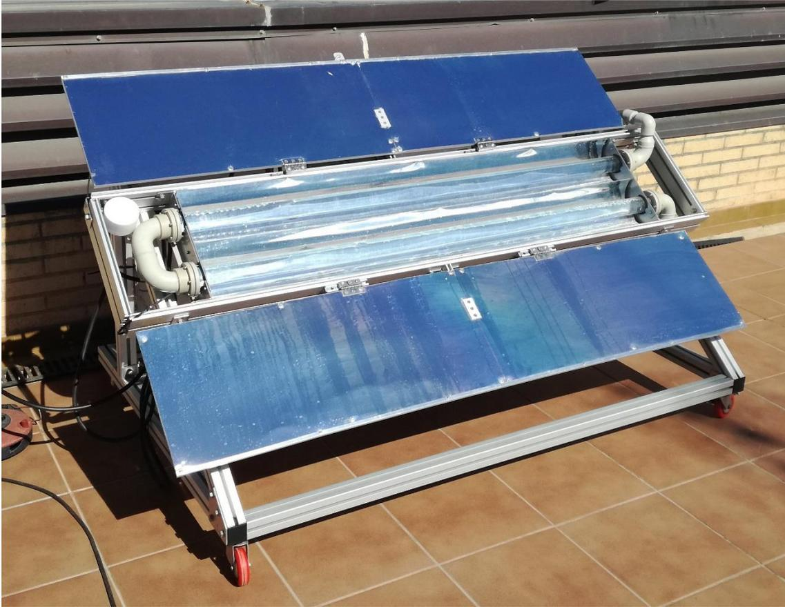
Imagen 11.3. Planta piloto sin el uso de los espejos para el contaminante Acetamiprid
