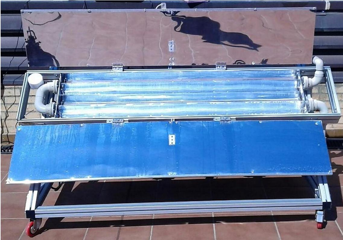
Imagen 11.4. *Planta piloto con el uso de los espejos para el contaminante Acetamiprid*
