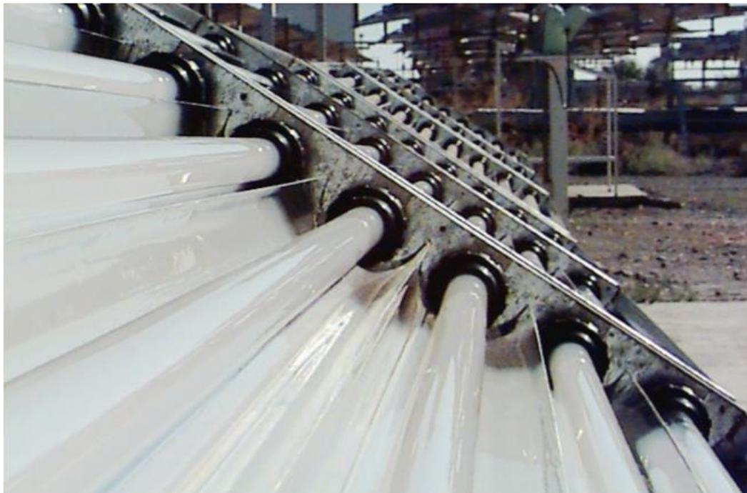
Imagen 1.2. Detalle de un colector CPC donde se observa la configuración de los tubos reactores
