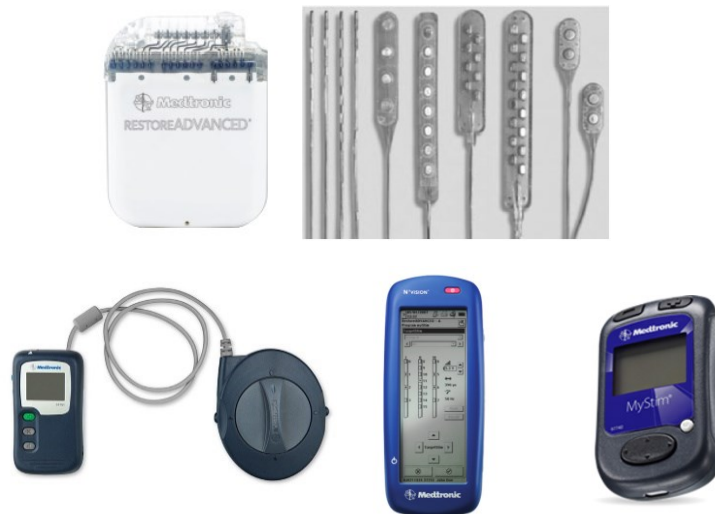
Figura 1. Elementos que conforman el sistema de EME. a) Neuroestimulador [8]. b) Diferente tipología de electrodos de estimulación percutáneos [10]. c) Cargador del neuroestimulador del paciente [11]. d) Programador del clínico [8]. e) Mando/programador del paciente [12].
