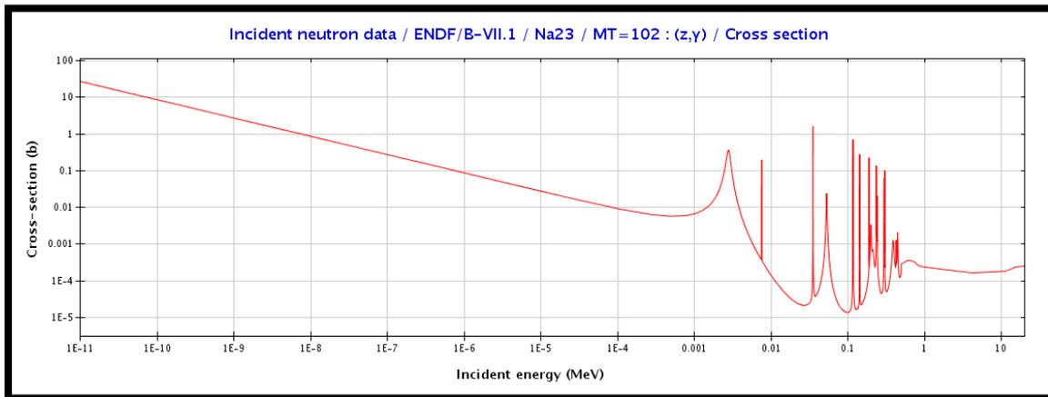
Ilustración 10: Sección eficaz de la reacción Na-23 (n,γ) Na-24
