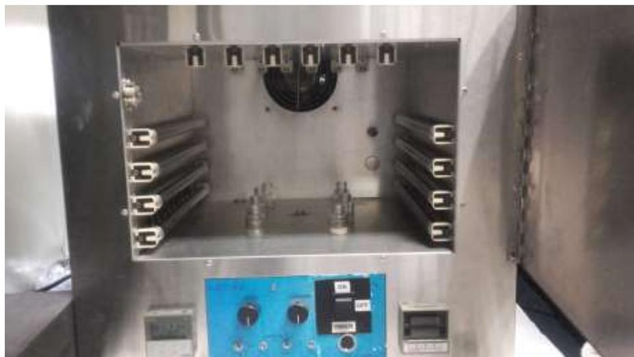
**Figura 12. Interior del fotoreactor utilizado**
