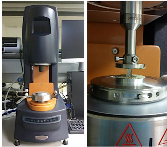
Figura 29. Emplazamiento de una muestra en el reómetro (Nota: la geometría de la muestra mostrada en la fotografía es diferente a la empleada)
