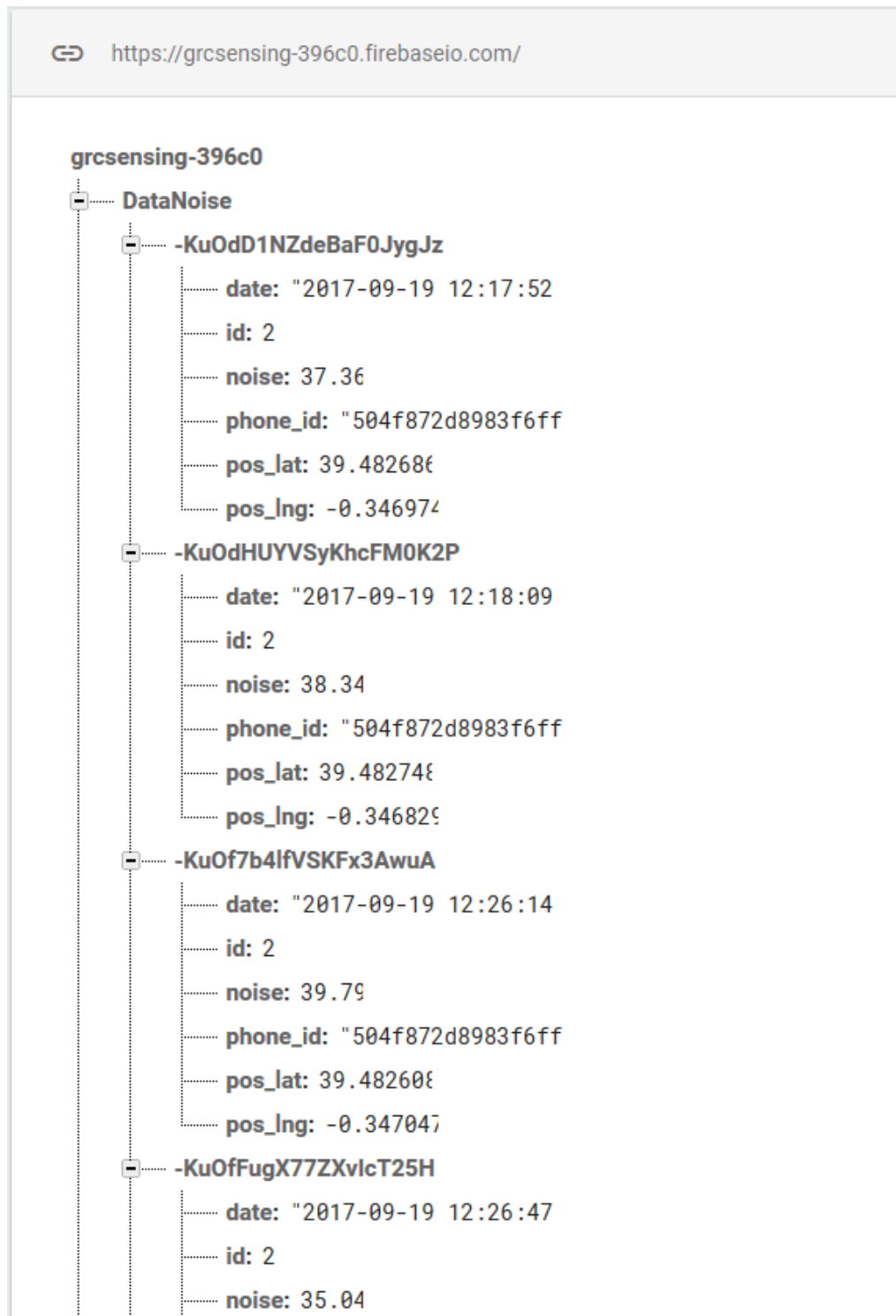
Figura 28. Consola de administración Firebase: verificación de registro de nivel de ruido.
