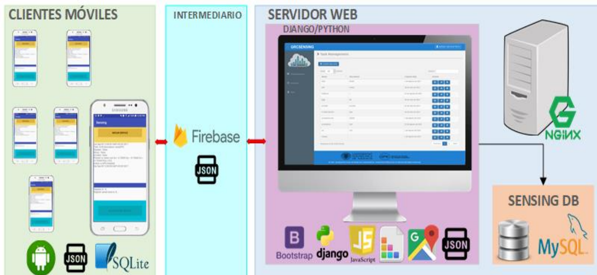
Figura 14. Esquema general de tecnologías utilizadas para la elaboración del sistema de monitorización.
