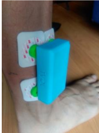
Ilustración 9. Prototipo de medición de bioimpedancia para detección de insuficiencia cardiaca. Desarrollado por la UPC, usando el sistema IVOL (Rosell Ferrer, 2016)
