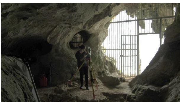
Figura 5: Equipo realizando el levantamiento topográfico de la cueva Venta Laperra
