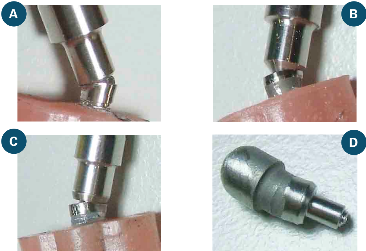
Figura 4. Modo de fracaso ante cargas estáticas: (a) UCS33, (b) PZIM35, (c) CO41 y (d) PDINT.
