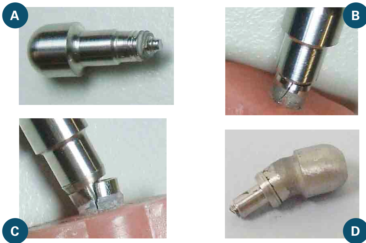
Figura 6. Modo de fracaso ante cargas de fatiga: (a) UCS33, (b) PZIM35, (c) CO41 y (d) PDINT.
