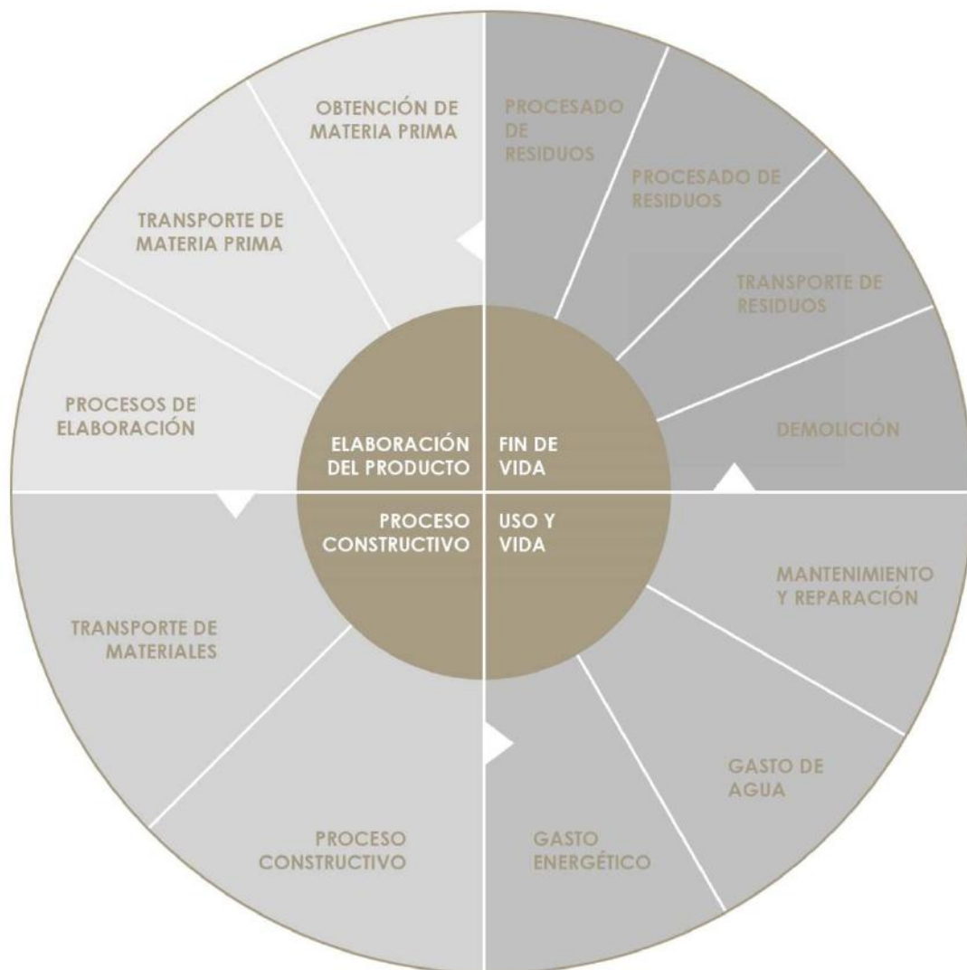
Figura 27. Esquema de ciclo de vida y sostenibilidad del edificio contemporáneo. Fuente: Elaboración propia.
