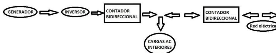
*Figura 5: Diagrama de bloques de un SFCR enfocado al autoconsumo (la orientación de las flechas indica el sentido de los flujos de intensidad de corriente)*
