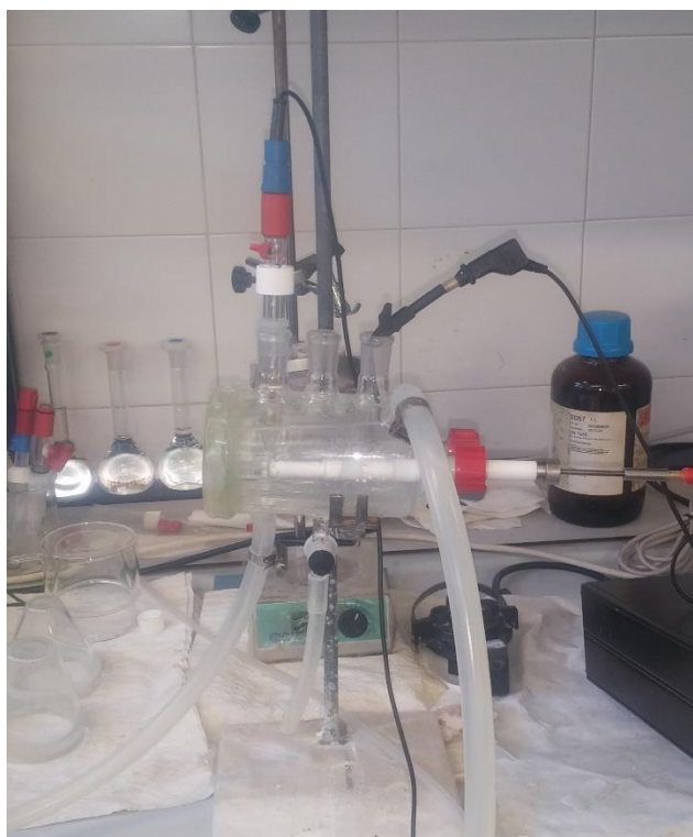
Figura 4.7. Fotografía de la celda electroquímica horizontal utilizada durante los ensayos de la obtención de las curvas de polarización de estado estacionario.
