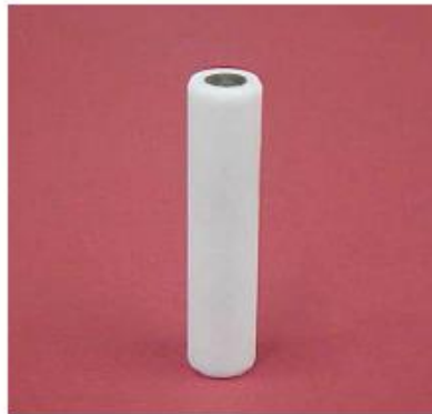
Figura 4.1. Imagen del electrodo de trabajo, material sustrato acero inoxidable AISI 304.
