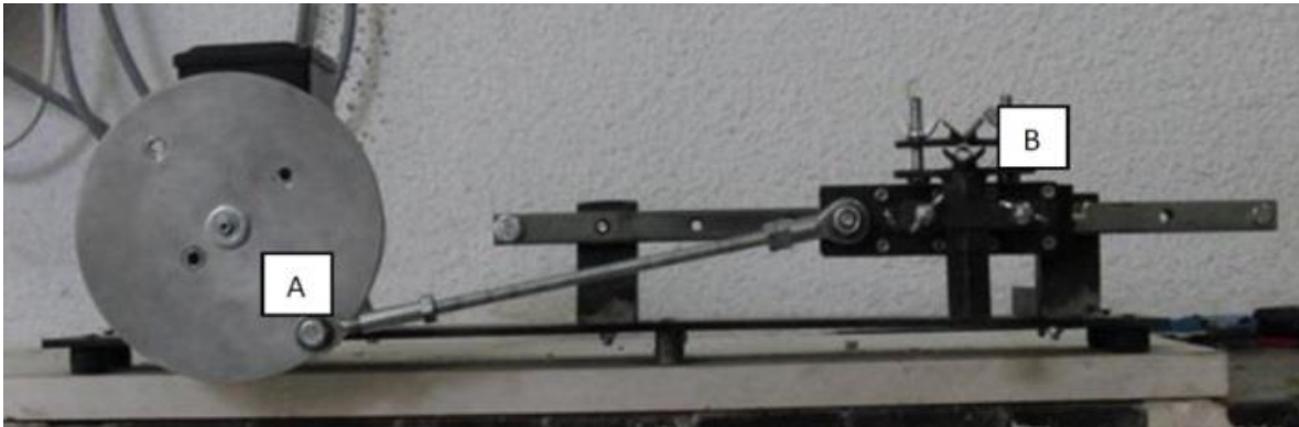
Figura 2. Dispositivo de vibrado mecánico. A: Disco con orificios simulando las diferentes carreras. B: Sistema de sujeción de la rama
