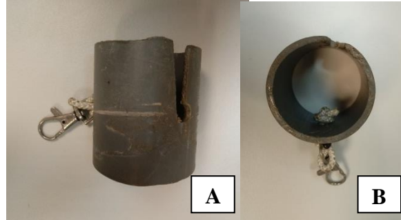
Figura 6. Pinza de agarre de frutos grandes utilizada para los ensayos de tracción. A: Detalle del agujero de agarre. B: Detalle de la pinza
