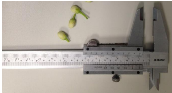
Figura 7. Pie de rey "Koke" utilizado para medir los calibres de los frutos y flores.
