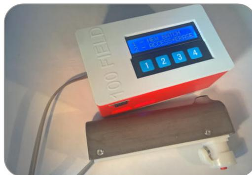
Figura 10: Durómetro Agrost 100 Field (<http://www.agro-technologie.es>).
