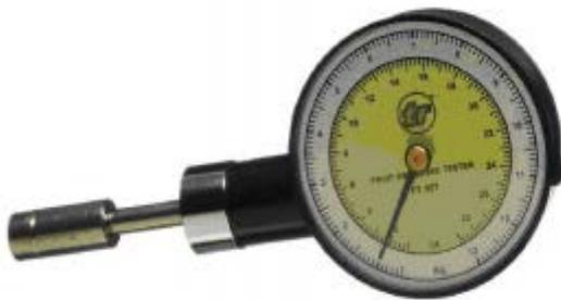
Figura 6: Penetrómetro modelo F.T.327 (Effegi).
