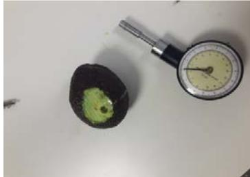
Figura 16: Durómetro manual con el vástago Magness-Taylor de 8 mm de diámetro.
