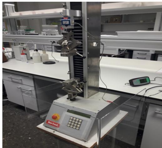
Figura 17: Máquina universal de ensayos Ibertest.
