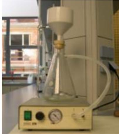
*Figura 3.6. Bomba de vacío utilizada para la obtención de SST*
