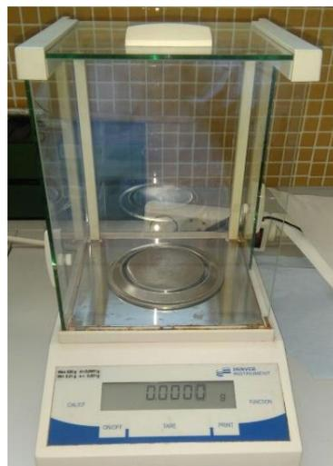
*Figura 3.5. Balanza analítica utilizada para la obtención de SST*
