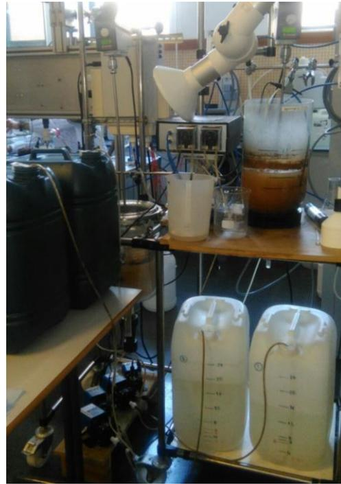
Figura 3.1. Montaje experimental del reactor biológico secuencial discontinuo
