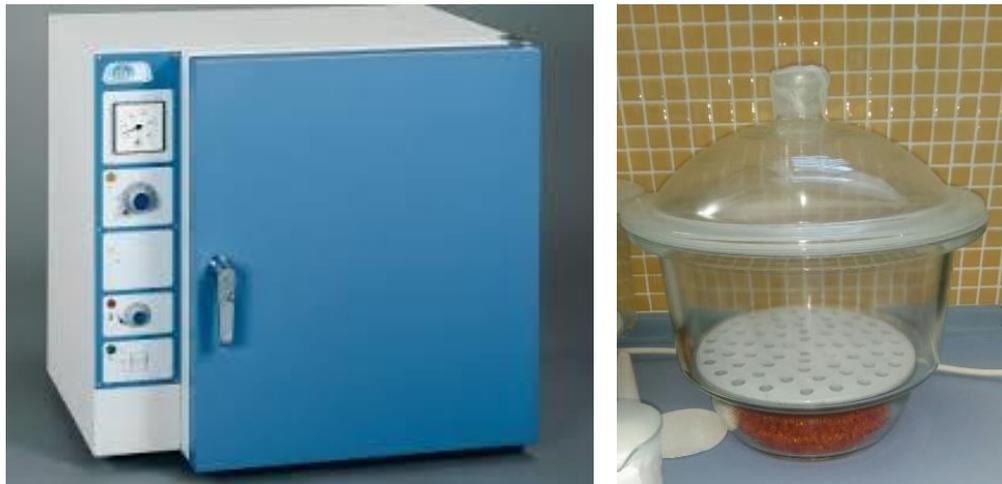
*Figura 3.7. Estufa y desecador utilizada para la obtención de SST*
