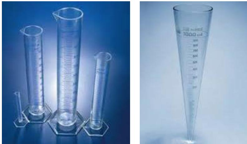
*Figura 3.4. Material utilizado para la obtención de los sólidos decantados*
