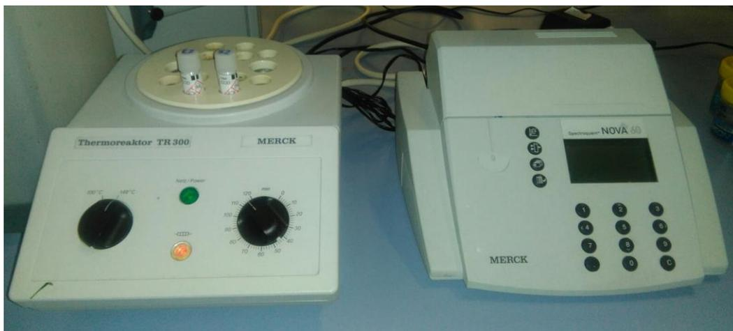
*Figura 3.8. Termo reactor y fotómetro utilizados para la obtención de la DQO*
