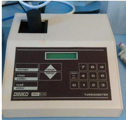
*Figura 3.9. Turbidímetro*
