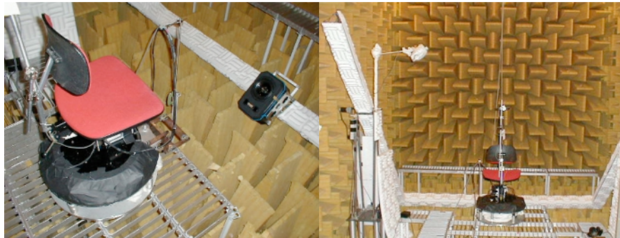
Fig.6. Detalle del método de medida de las HRTF.
