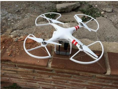
Fig. 2- Cuadricóptero con cámara adaptada para la toma de fotografías.
