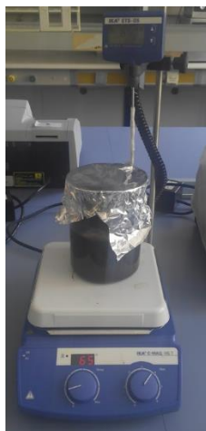
Figura 3.3-1 Agitador magnético con calefacción IKA® C-MAG HS 7 equipado con un termómetro de contacto IKA® ETS-DE
