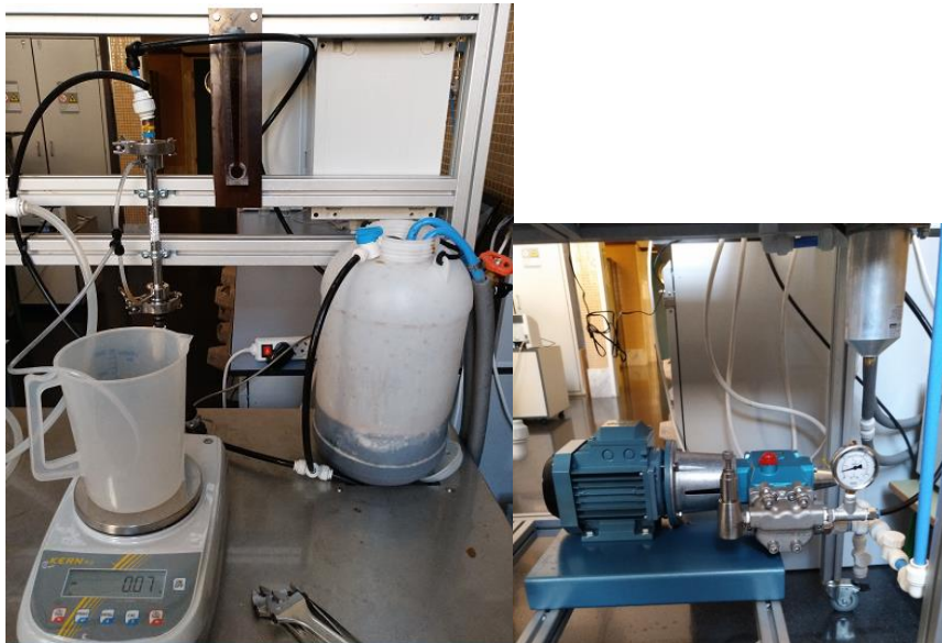
Figura 3.3-3 montaje experimental empleado para la ultrafiltración. Derecha: Depósito con resistencia para el control de la temperatura, caudalímetro, soporte con la membrana y recipiente receptor del filtrado. Izquierda: bomba con manómetro para la impulsión del fluido y filtro de seguridad.
