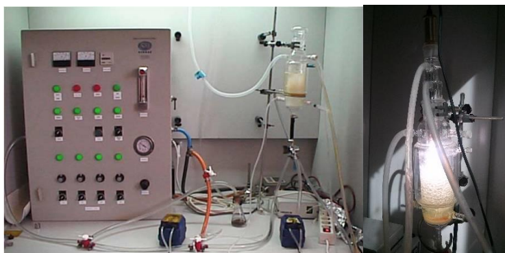
Figura 3.2-4 Generador de ozono Ozogas T.R.C.E. 4000 (izquierda) y reactor cilíndrico de vidrio con lámpara de xenón de inmersión axial sumergida (derecha)
