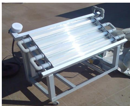
Figura 3.2-3 Planta pilo de fotocatalisis solar de 4L.
