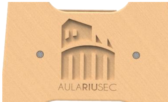
Fig. 16. Detalle grabado láser
