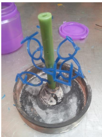
Fig. 14 Anells disposats en un arbre de colada.
