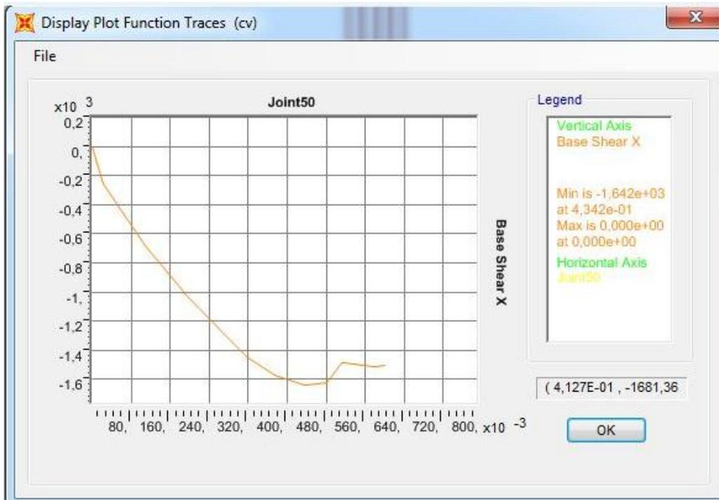
Figura 44: Curva de capacidad - Control de desplazamiento - 9 pisos
