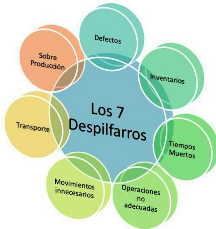
Figura 1. Las 7 pérdidas. Fuente: Supply Chain.
