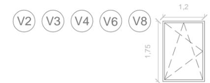
Ventana de un hoja oscilo-batiente. Carpintería de aluminio con rotura de puente térmico y vidrio bajo emisivo.
