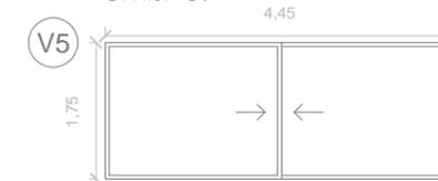
Ventana de dos hojas corredera. Carpintería de aluminio con rotura de puente térmico, y vidrio bajo emisivo.
