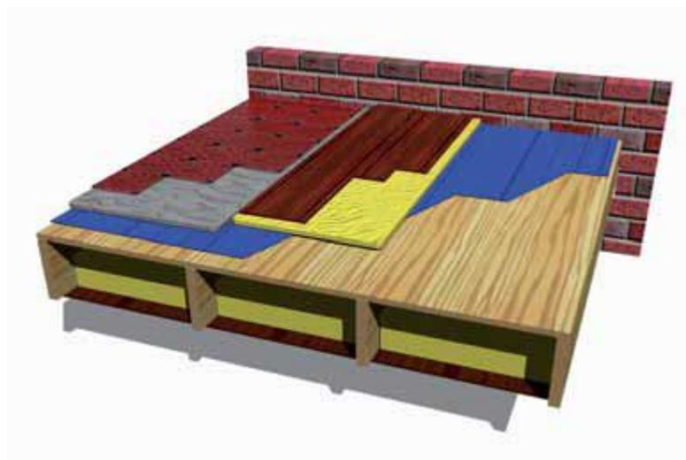
Ilustración 59. Detalle de componentes de panel autoportante para forjado. Fuente: Catálogo Finforest KERTO
