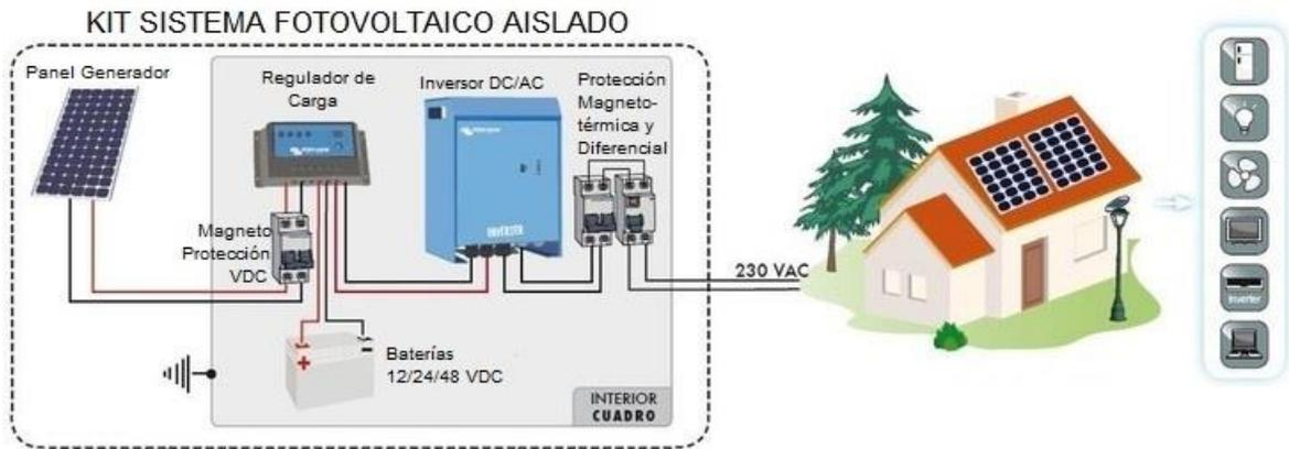
Ilustración 87. Funcionamiento de sistema fotovoltaico. Fuente: [ingemecanica.com](http://ingemecanica.com)
