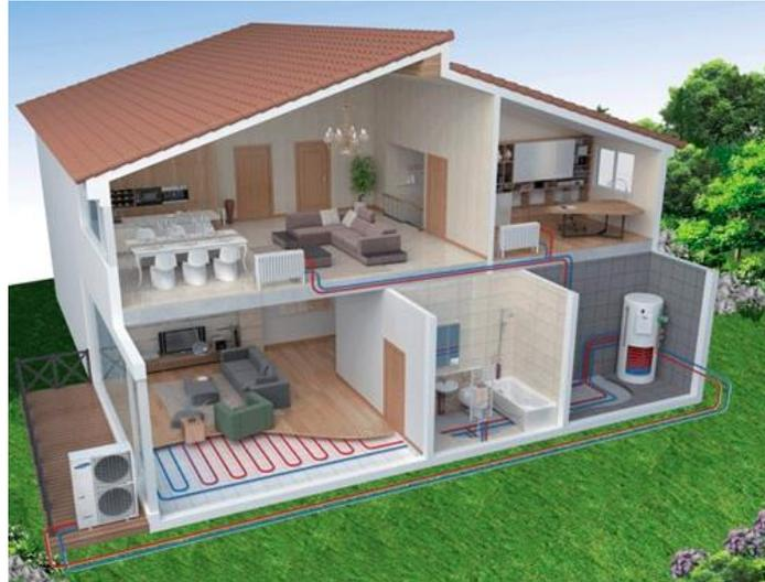
*Ilustración 32. Funcionamiento de aerotermia. Fuente: solvento.es*
