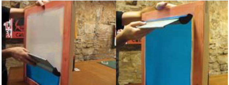
Fig. 42: Colocación de la raedera y extendido de la emulsión sobre la malla.
