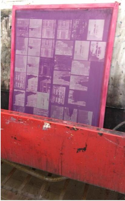
Fig. 41: Lavado de pantalla con agua después de haber sido insolada.
