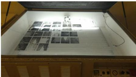
Fig. 40: Insoladora con la luz blanca encendida y fotolitos colocados debajo de la pantalla.
