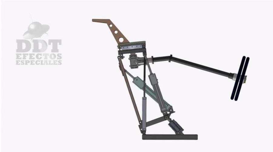
Figura 40: Mecanismo de la cabeza del monstruo.
