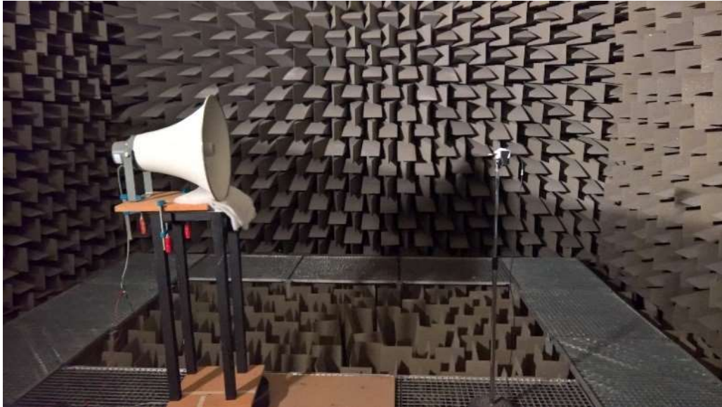
Figura 15: Montaje para la medida de respuesta en frecuencia y directividad en cámara anecoica
