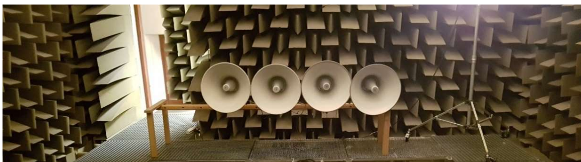
Figura 22: Construcción del Line-Array de megafonía
