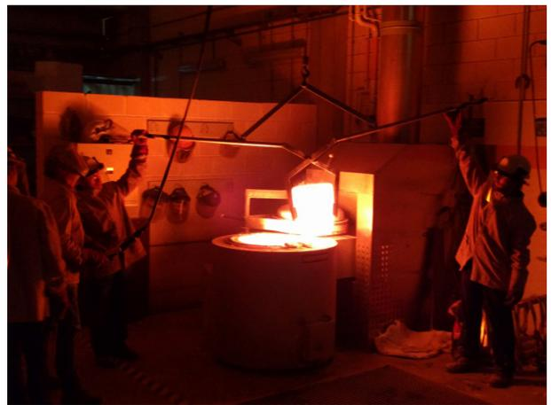
Imagen 33 - Sacando el crisol con bronce del horno
