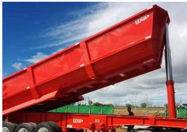
Figura 6 Ejemplo de extensibilidad de sistema hidráulico.
