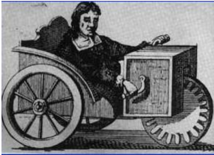
Figura 3 Vehículo autopropulsable de Stephen Farfler.
