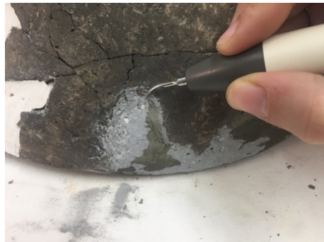
Fig. 17. Eliminación del estuco grisáceo empleando lápiz ultrasonidos.
