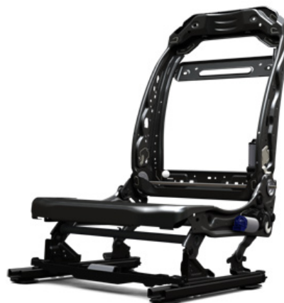
Figura 39. Estructura del asiento
