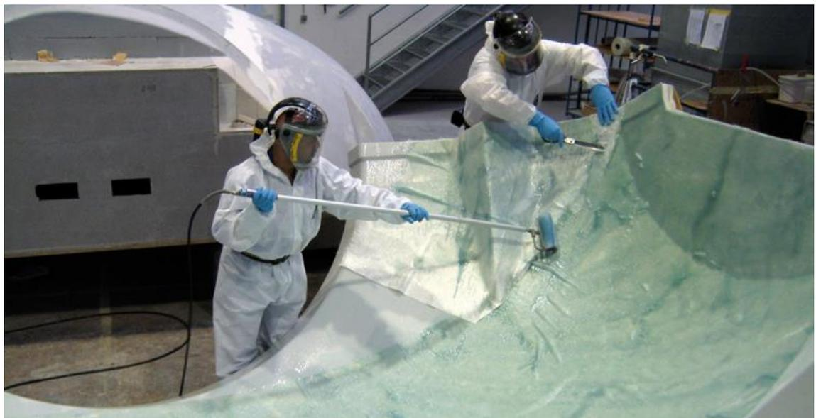
Figura III.71. Proceso de moldeo por contacto a mano.
