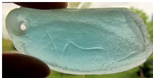
Figura 8. Réplica física impresa en resina XHD translúcida con un espesor de capa de 16 micras.
