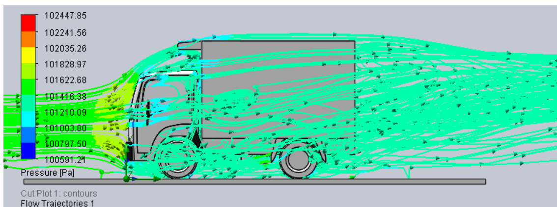
Ilustración 30 Líneas de flujo en vista lateral del modelo reformado.
