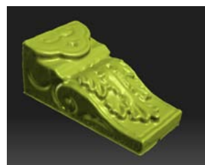
Fig. 7. Ménsula medida con escáner SENSE de 3D Systems
